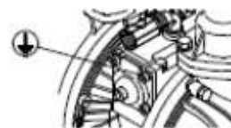
Obr. 3.3d Typ 40/50/80 Pozice pro připojení zemního vodiče
