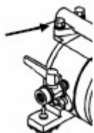
Obr. 3.3b Typ 5/10/15 Pozice pro připojení zemního vodiče
