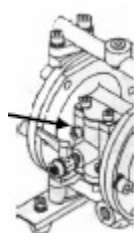
Obr. 3.3c Typ dp10 Pozice pro připojení zemního vodiče
